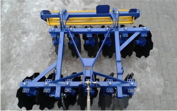
Борона почвообрабатывающая используется для безотвальной обработки почвы с одновременным рыхлением глыб, выравниванием поверхности почвы и её прикатыванием. Машина может быть использована также для вымешивания высеянных минеральных удобрений и извести с почвой.
